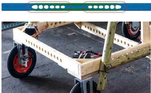
ベースフレーム・サイド 剛性/質量の構造最適化
