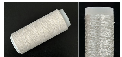
ドライファイバーテクノロジーで解繊したコットン再生セルロース繊維(左:乾式紡績、右:湿式紡糸)
