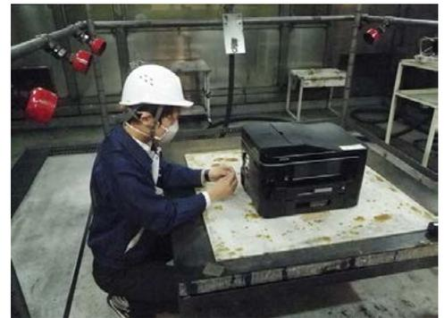
燃焼試験室における燃焼性試験
