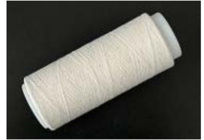
ドライファイバーテクノロジーで解繊した繊維を50%使用したコットンの糸（試作）
