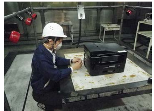
燃焼試験室における燃焼性試験
