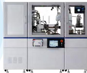
射出成形～検査～トレイ詰めまでを柔軟に対応できる、汎用性と拡張性を備えたコンパクトな生産システム
