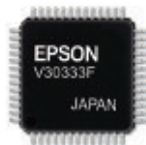
組み込みアプリケーション向け 音声ガイド・オーディオデコードLSI*1 [S1V3033x]シリーズ
