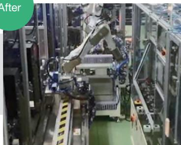
当社のプリントヘッド組み立て工程における自動化導入事例。社内の製造ノウハウをベースにした自動化要求に応えるソリューションの提案が可能。
