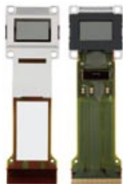
0.7 型フルハイビジョン対応 高温ポリシリコンTFT液晶パネル
