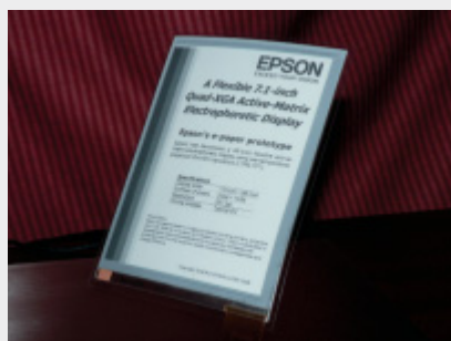
A6サイズ(7.1インチ対角)電子ペーパー試作品
