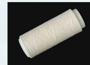
ドライファイバーテクノロジーで解維した繊維を50%使用したコットンの糸（試作）
